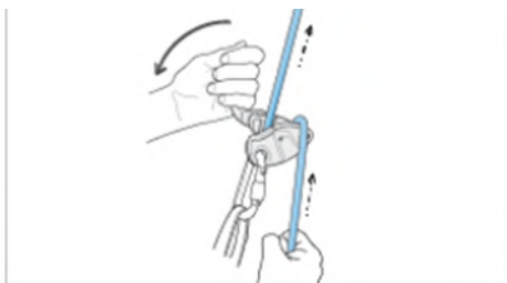
Εικ.17: Κατέβασμα σχοινοσυντρόφου( Petzl.com)
