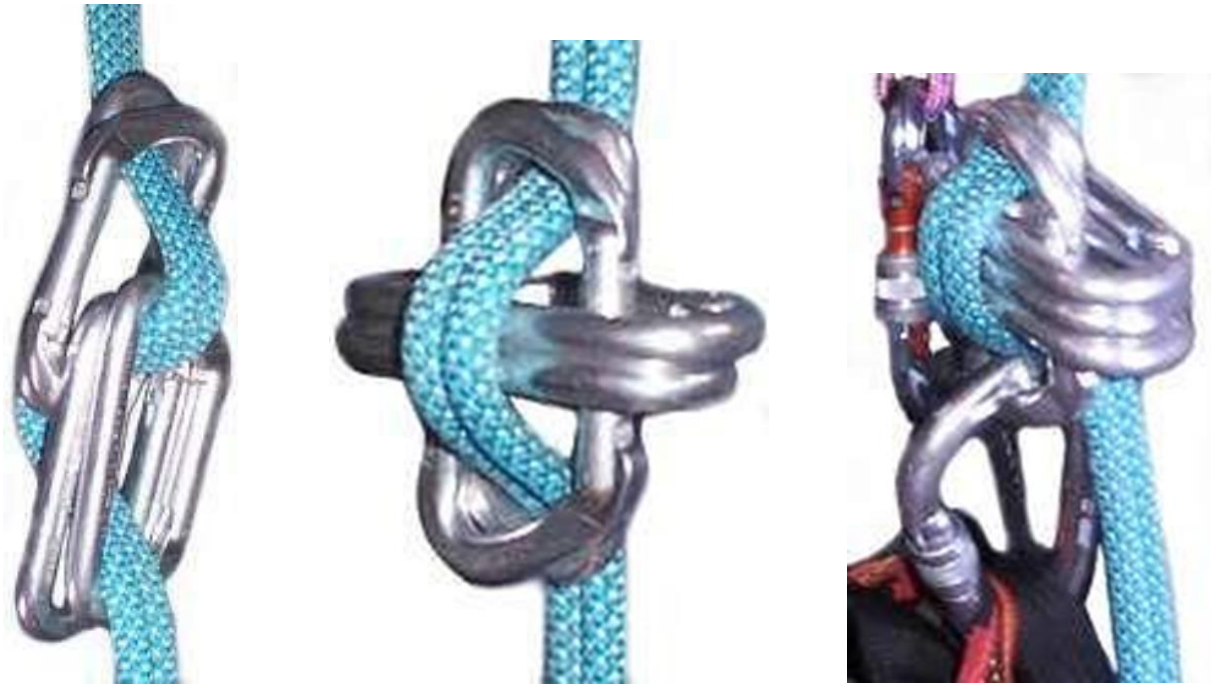
Εικ. 7,8,9: Διαμόρφωση συστήματος κατάβασης με σταυρωτά καραμπίνερ και ένωση με καραμπίνερ ασφαλείας στο μποντριέ
