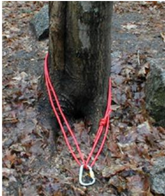
Εικ. 20: Αγκύρωση χωρίς κόμπο-μέτρια
