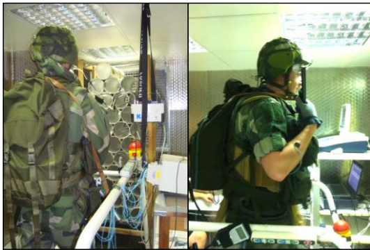
Εικόνα 5: Δοκιμαζόμενος με πλήρη εξάρτηση εκστρατείας κατά την προσομοίωση παρατεταμένης βάρδισης σε διάφορες περιβαλλοντικές συνθήκες (από 20 °C έως 45°C και με υγρασία από 20-70%) με και χωρίς άνεμο. Στην αριστερή πλευρά διακρίνονται στο βάθος ο ανεμιστήρας και οι σωλήνες ομοιόμορφης κατανομής του αέρα στο σώμα. Στην δεξιά εικόνα διακρίνεται ένας από τους πολλούς αισθητήρες αποβολής θερμότητας στο δεξί άνω άκρο του δοκιμαζόμενου.
