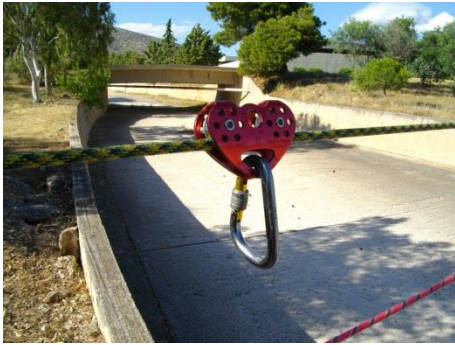
Εικ. 9: Συσκευή tandem με Καραμπίνερ ασφαλείας
