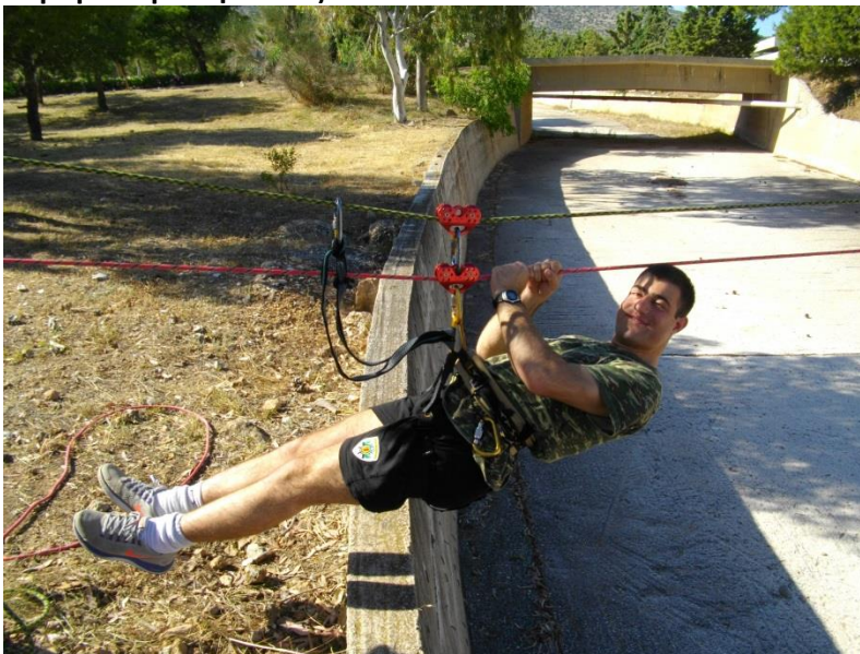
Εικ. 11 : Διαπέραση με δύο tandem και επιπλέον «ασφάλιση» με αυτασφάλεια
