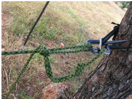
Εικόνα 3 : Κλείδωμα «μουλαρόκομπου» ασφαλείας στο ρελέ
